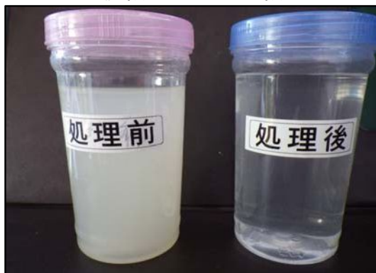
沈殿処理水比較(45分間) 処理前濁度 420 / 処理後濁度 30
