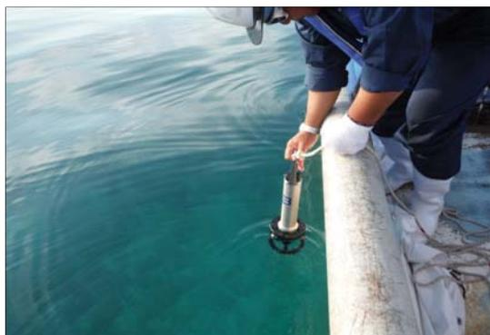
濁度計による計測状況
