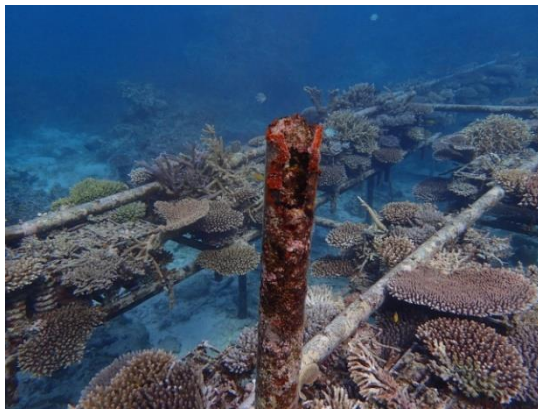
穴があいた単管パイプ
