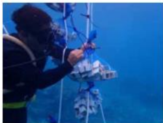
着床具入り網袋の吊り下げ状況（ロープ付EVAフロート取付け）
