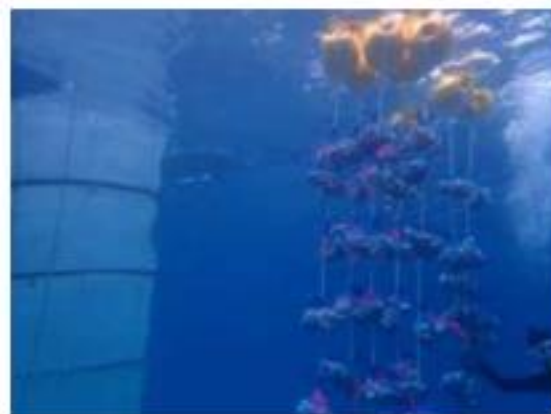
着床具入り網袋の吊り下げ状況（ロープ付EVAフロート取付け）
