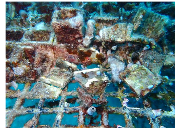
着床具の破損状況(D-7)
