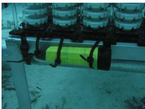
図Ⅱ.5.9 架台に取り付けた自記式水温計
