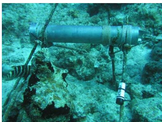
図Ⅱ.9.8 濁度計設置状況（右下は自記式水温計）
