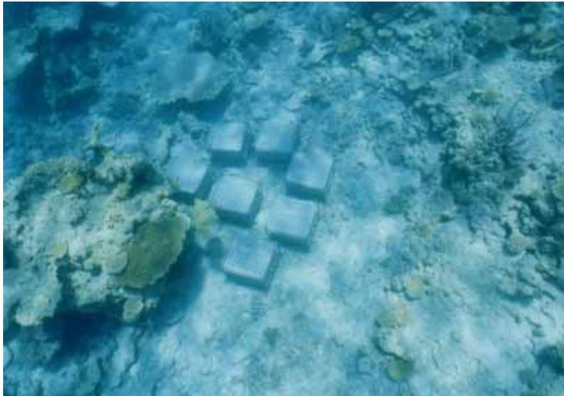
図 6-6 . 海中に設置した着生具フレーム
