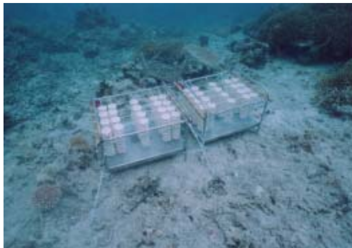
図6 海底に固定された着床具ケース
