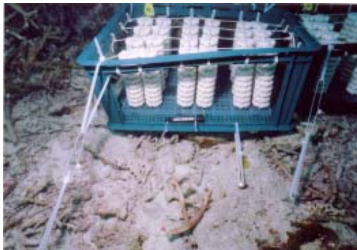
図7 固着された自記式水温計
